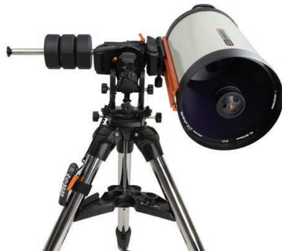
Abbildung 6 Ausbalancieren der Montierung
